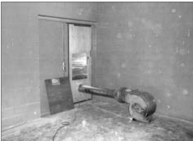
FOTO'S VAN DE MEETOPSTELLING VOOR DE LUCHTDICHTHEIDSMETINGEN.
